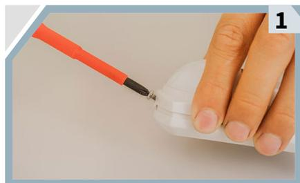
**Desatornilla levemente** el sensor de movimiento hasta que te permita abrirlo, pero **no retires el tornillo**.
