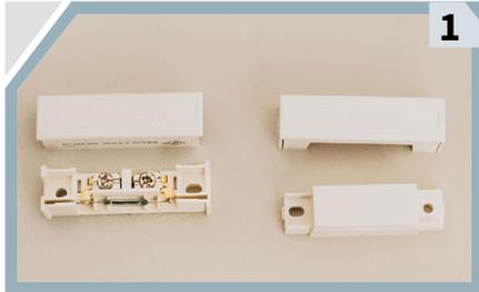
**1** **Identifica la parte fija y móvil del sensor.** Para ello puedes abrirlos para ver su interior: la que tiene tornillos por dentro es la parte fija.
