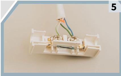
**Afloja los tornillos de la parte fija e introduce los pares de cables**, un par en cada tornillo, aquí no hay polaridad, así que puedes conectarlos como desees. No olvides apretar los tornillos.
