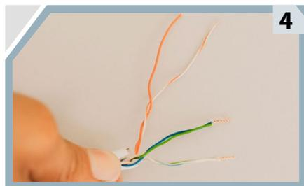
**Elige tres pares de cables** y enrosca o trenza dos pares de sus extremos de cobre.
