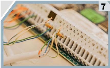
De igual manera, usa una resistencia para conectar el **sensor magnético** a la **terminal del común del panel**.
