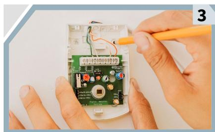
**Marca** los orificios en la pared donde instalarás el sensor.
