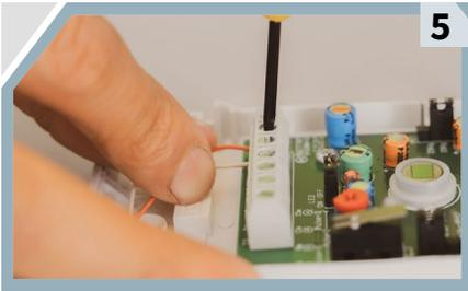
Elige un par de cables que no trenzaste, uno será para la terminal positiva y otro para la terminal negativa. **Ubica el puerto del sensor** y en la terminal donde se indican los **voltios**, afloja un poco el tornillo de la **terminal positiva** y **conecta el primer cable**. Vuelve a atornillar.
