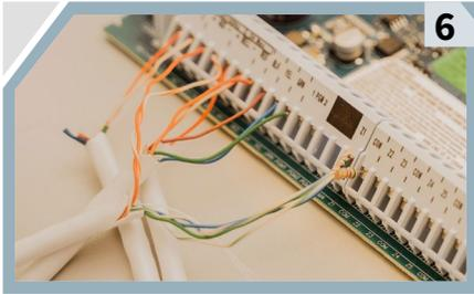
Conecta el **sensor de movimiento**, primero coloca los cables del voltaje a la terminal **auxiliar del panel**, luego los de la terminal **NC y por último al común**.
