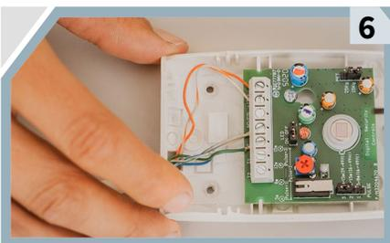
**Conecta** el otro cable a la **terminal negativa**, y un par de los cables que trenzaste al **común** y los otros a la terminal **NC o normalmente cerrado**.
