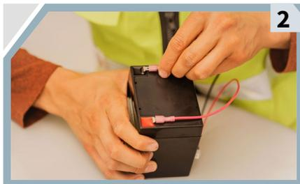
Comienza con la **batería**, utiliza sus cables para conectar el **positivo** a la **terminal positiva** y el **negativo** a la **terminal negativa**.
