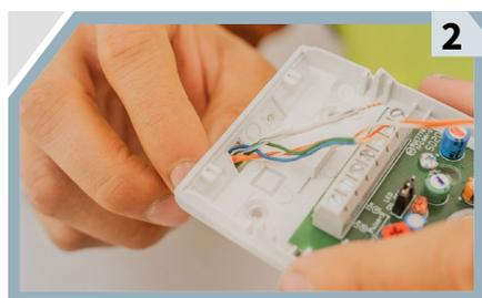
**Haz un orificio** en la parte superior al sensor para meter el cable UTP (ya viene marcado el espacio).
