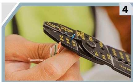
**Pela todos los cables de colores** con alicates pelacables: **3 o 4 mm (0.16 in)** hasta dejar los cables de cobre al descubierto.
