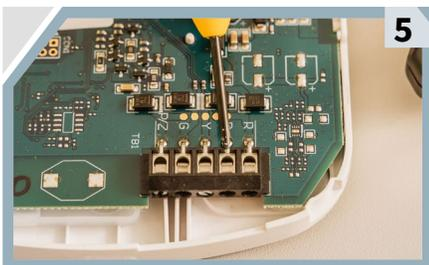
Toma la otra parte del teclado y **localiza el puerto**. Tiene cinco terminales, pero nada más ocuparás las primeras cuatro, usualmente, vienen nombradas con las iniciales de un color en inglés: *red*, *black*, *yellow* y *green*. Para cada una de estas terminales, afloja el tornillo, y conecta un único cable de color lleno en cada terminal, sin enroscar y atornilla.
